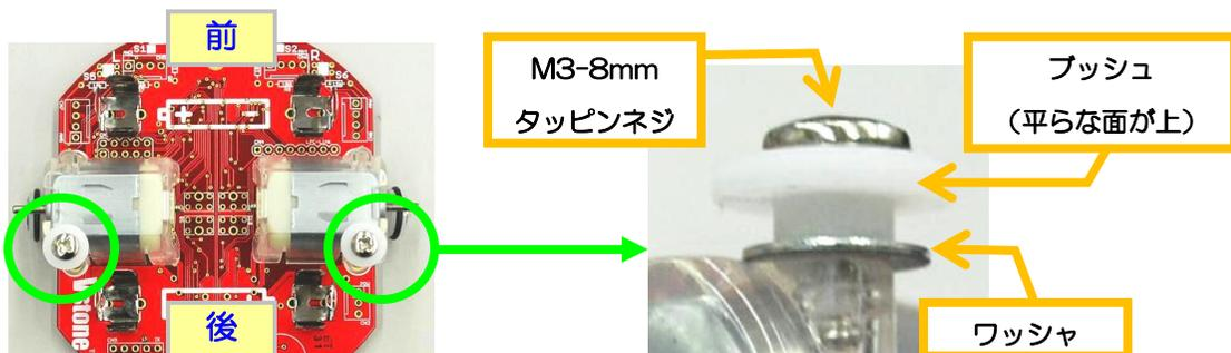
【②】 ロボットの上から、ネジ止めした部分をユニバーサルボードの穴に通し、スライドさせます。
