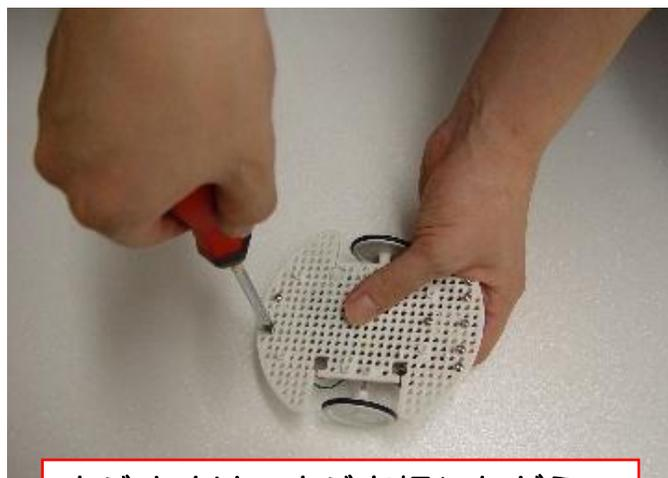
ネジ止めは、ネジを押しながら、ドライバーを回します。
