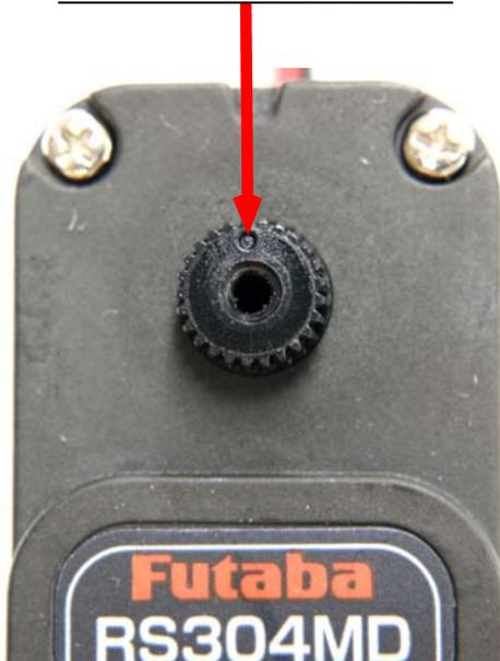
サーボホーンを取り外す際にサーボモータが回ってしまうと、出力軸の○印が中心からずれた状態となってしまいます。
