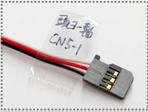
写真に示すように、それぞれのケーブルにサーボモータの名称・取り付け位置をメモしたシールを貼っておくと、あとの作業が容易になります。
