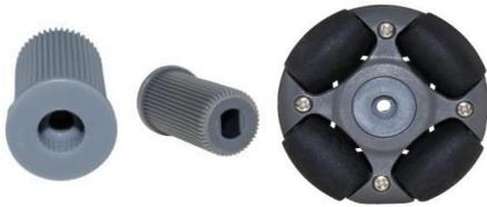
本商品には軸受が付属しています。軸受はサーボモータやTTモータとの連結に使用されます。サーボモータと連結する際は軸受の前部、TTモータと連結する場合は後部を使います。また、軸受にはネジの取付けが必要です。
