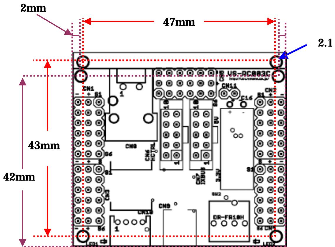
また、VS-RC003 用の各種拡張ボード (VS-IX001,VS-IX004,VS-IX007,VS0IX008 の 4 種類) におけるマウント穴は以下の通りです。
