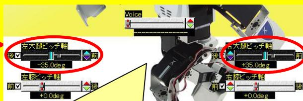
その状態でマウスのホイールをまわすと、色が変わったポーズスライダにおいて、角度が同じように変化し、左右の関節を同時に同じ角度だけ動かすことができます。
