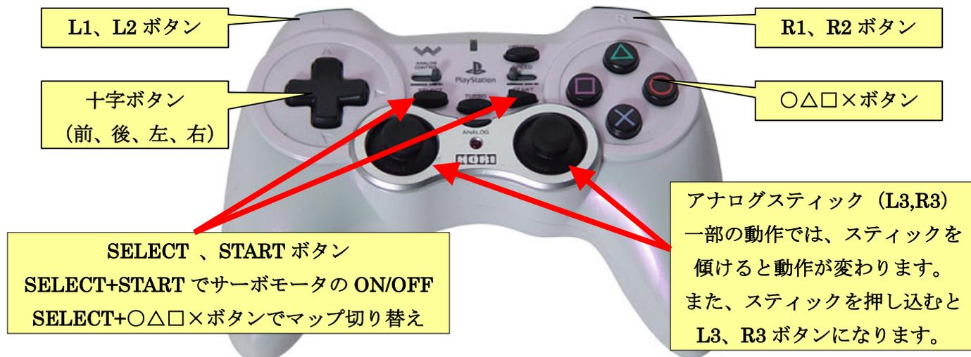
ロボットの基本的な操縦方法は、任意のボタンを押すことでそこに割り当てられたモーションを再生するという形式ですが、一部の動作については、ボタンを押した後に追加で操作したり、ボタンを押す長さ・組み合わせなどボタンの押し方で動きが変わったりするものもあります。また、初心者向けと上級者向けの操作方法は基本的に共通した構造になっていますが、一部のボタンについて異なる動作を割り当てています（詳しくは次ページ以降の解説をご参照ください）。
