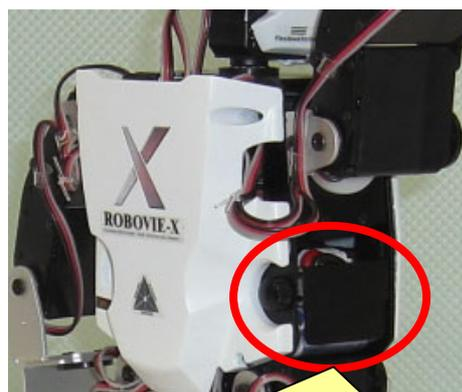
バッテリーを接続したら、ロボット本体の電源スイッチを「ON」にしてください。なお、サーボモータを ON にした瞬間に、ロボットが勝手に動いて、指を挟みこみや周りのものとぶつかって事故や故障を起こすなどの危険性があるので、必ずロボットの腰をつかんで、ロボットを片手で持ち上げた状態で行ってください。
