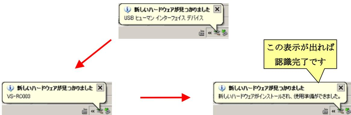
一度 PC が CPU ボードを認識すると、次に接続した場合は上記フキダシを表示せず数秒で認識を完了します。PC が CPU ボードを認識すると、認識を知らせる音が数回 PC のスピーカから鳴ります。
