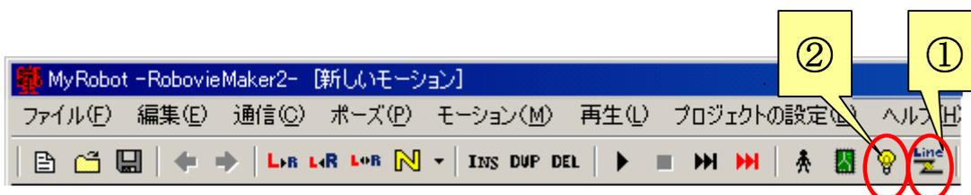
①のボタンをクリックすると PC とロボットが通信を開始し、②のボタンをクリックするとロボットのサーボモータが ON になります。
