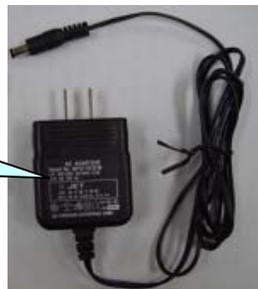
センサフロアタイルの接続枚数によっては、このような電力供給専用の基板を配線に挟みます。
