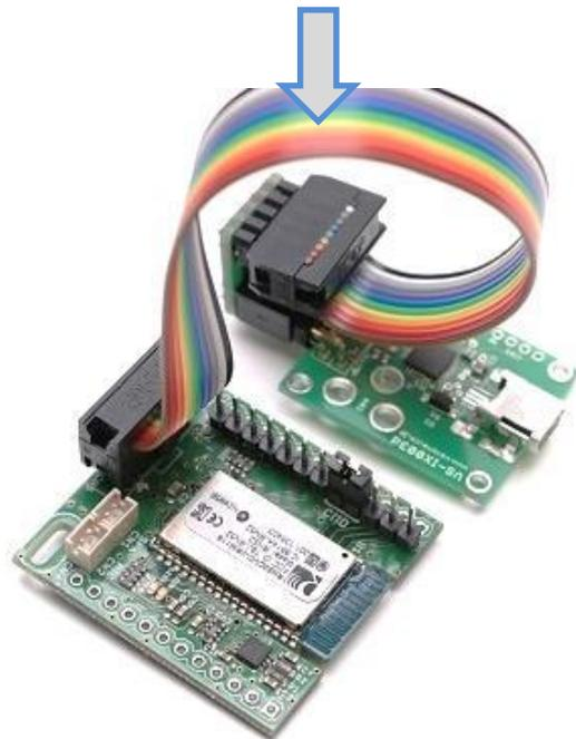
写真と同じ向きになるように VS-CN106 と VS-BT003 を 10 芯フラットケーブルで接続します。10 芯フラットケーブルの 1 番ピン(▽マークが描かれています)を VS-BT003 の 1 番ピンに接続します。
