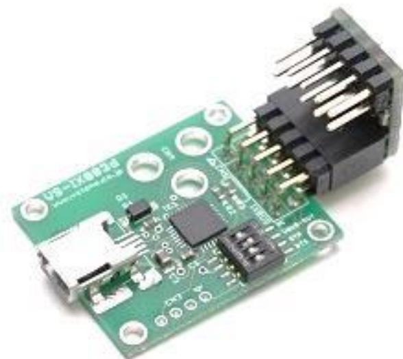
最初に**通電していない状態**で、VS-CN106 のピンソケットに VS-IX003 を接続します。(写真と同じ向きに接続してください)
