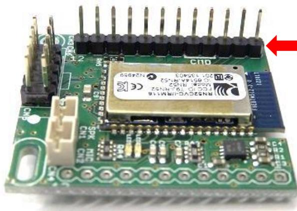
付属のピンヘッダを VS-BT003 にハンダ付けします。写真のように基板の表側にピンヘッダを配置します。
