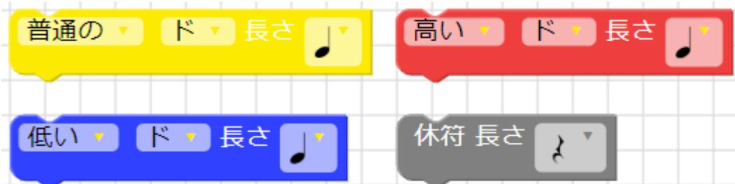
音の高さと長さを指定してブザーを鳴らします。高さは3オクターブ（低い・普通・高い）と音階を組み合わせ設定し、長さは実際の音符の記号と同じです。休符は長さだけを選択します。音の長さの基準は、四分音符が約0.5秒です。
