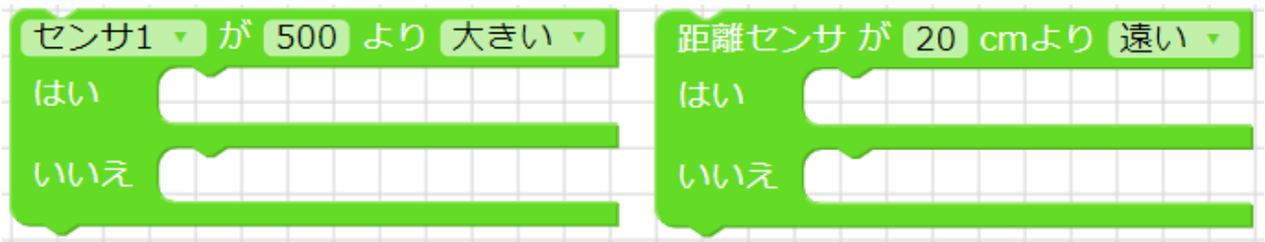
センサの値によってプログラムを分岐させます。センサ 1~3 と距離センサとで、ブロックの種類が異なります。いずれの場合も、「プログラム実行中のセンサの値」と「ブロックで設定した値」を比べて、センサの値が大きいか、小さいかによって、YES・NO の方にそれぞれ分岐します。
