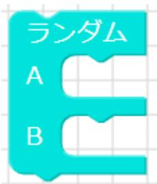
プログラム実行時に、ランダムで A・B いずれかの方に分岐します。それぞれに進む確率は必ず 50% です。
