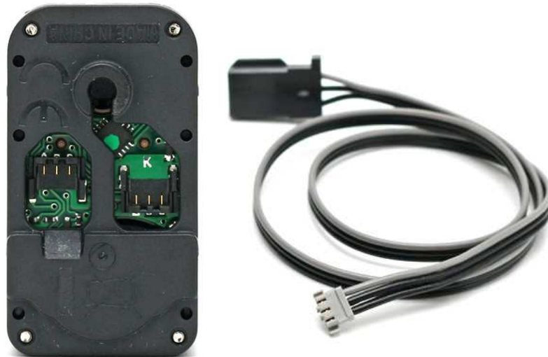
サーボモーター背面、および付属ケーブル
