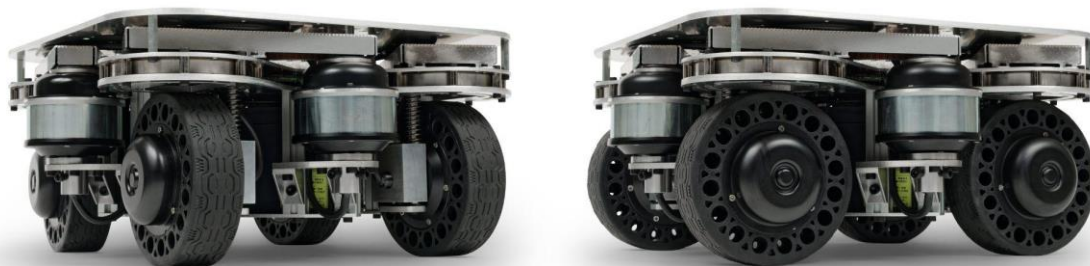
全ての駆動輪に独立したステアリングを搭載
