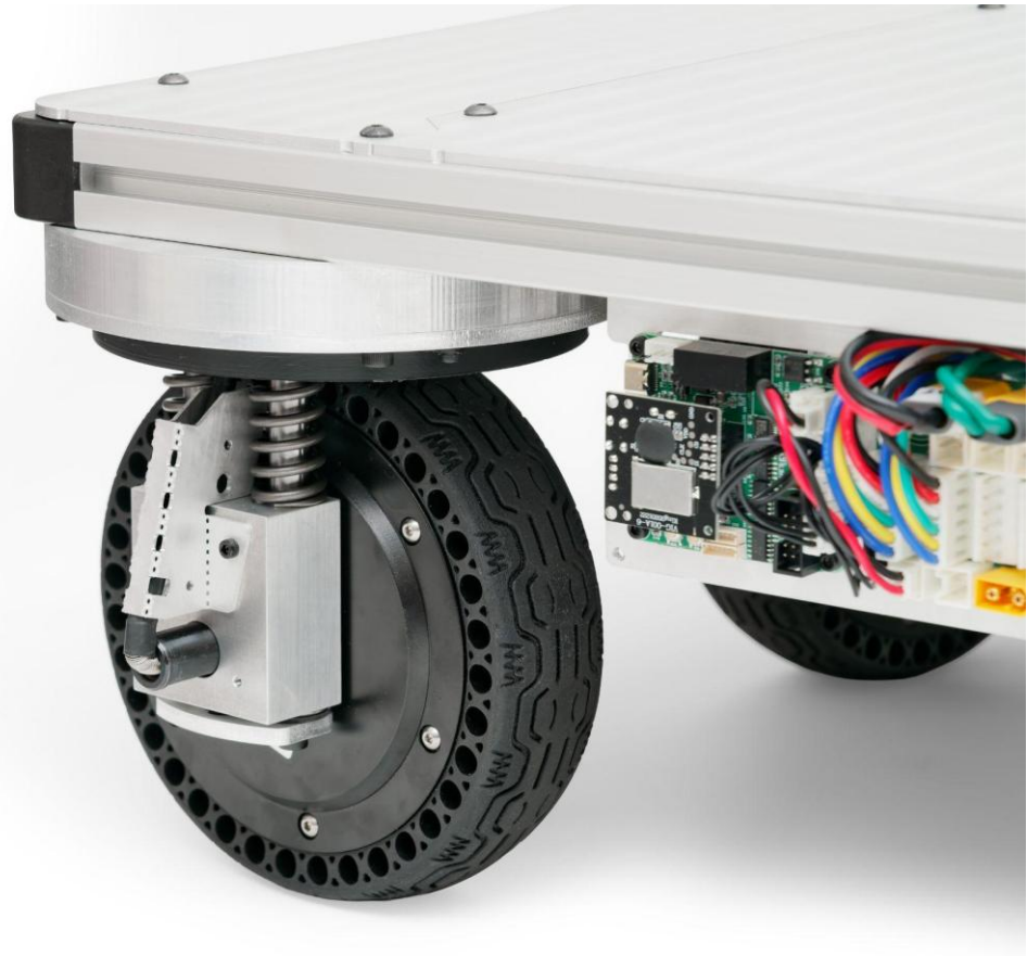
8輪すべてにステアリングとサスペンションを搭載
