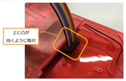
3) フラットケーブルを VS-IX008 に、コネクタの凸が基板の上側を向くように取り付けます。
