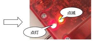
キャリブレーション完了後、赤色 LED が点灯し、橙色 LED が点滅します。
