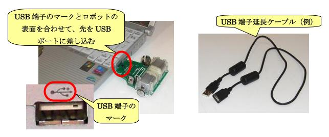
ロボットを PC に接続する場合、必ずロボットの電源スイッチを OFF にしてください。 電源スイッチが ON になっていると、通信が途切れたり勝手にモータが動いたりする場合があります。
